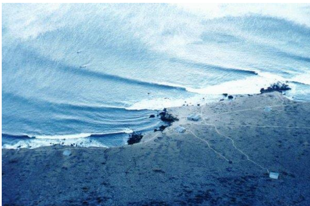
Figur 2.8 Et tydeligt eksempel på bølger der med en vinkel til kysten drejer ind mod stranden.
