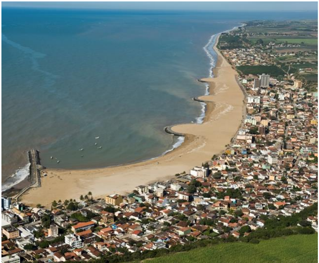
Figur 3.17 Kystbeskyttelse med tre forlande fra Brasilien.
