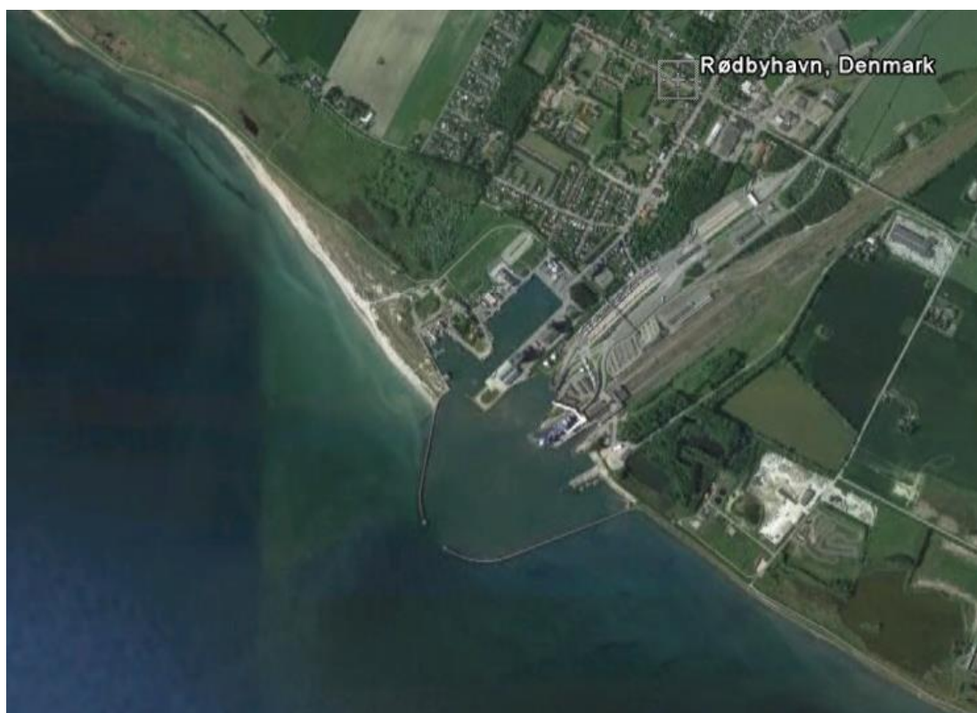
Figur 2.23 Luvside tilsanding nordvest for Rødbyhavn, hvor der er en netto langstransport på ca. 30.000 m 3 /år imod sydøst grundet fremherskende bølger fra vestlige retninger.
